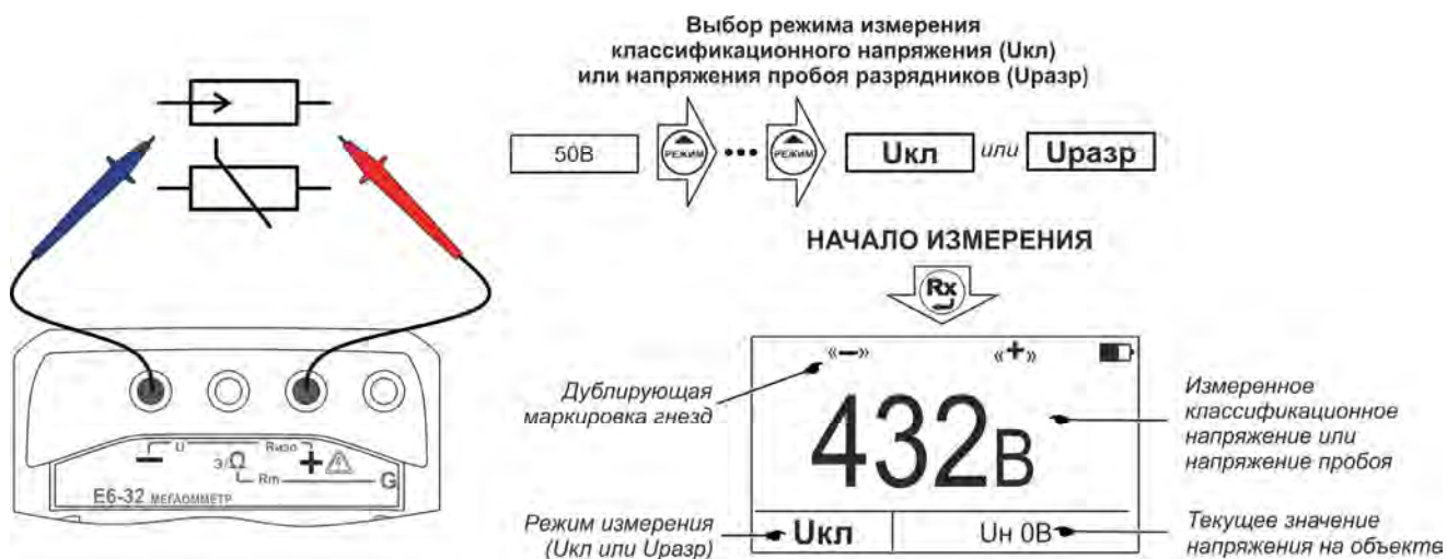
Рисунок 2.10 - Измерение классификационного напряжения или напряжения пробоя разрядников
