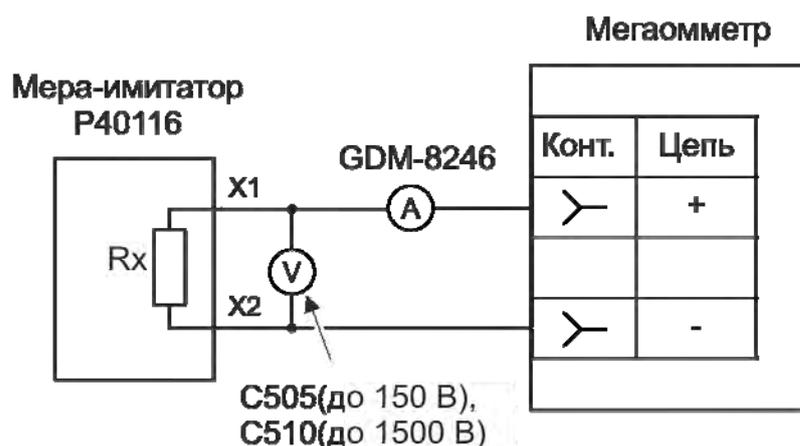
Рисунок 6.2 - Схема определения погрешности измерений классификационного напряжения
