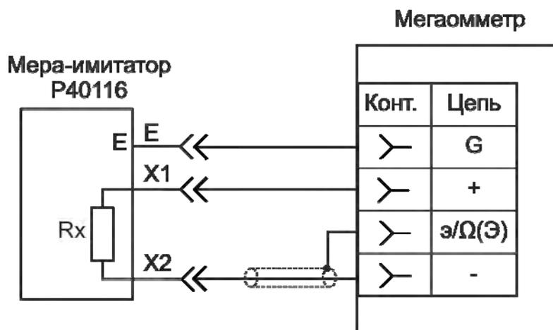
Рисунок 6.1 - Схема определения погрешности измерений сопротивления изоляции
