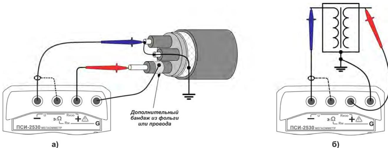
Рисунок 2.6 – Снижение влияния поверхностных токов утечки
