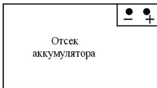
Рисунок 3.2.1 - Полярность подключения аккумулятора
